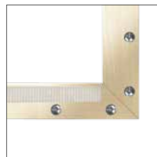
D Fissaggio della piastra al telaio in angolo
